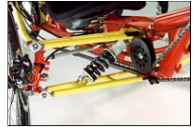
Formel1-Technik am Fahrrad. Der doppelte Querlenker bringt viel Spaß.
